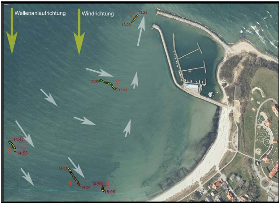
Abbildung 33: Strömungen bei nördlichen Winden (Stärke 5). Quelle: Autor (mit freundlicher Unterstützung der Universität Rostock)
