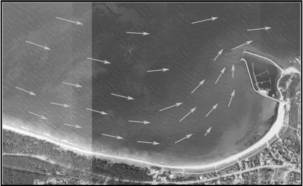
Abbildung 26: Strömungsmuster bei schwachen bis mäßigen Stromgeschwindigkeiten in der Glowe-Bucht. Quelle: Autor (nach GELLERT 1965, Luftbild: Mit freundlicher Unterstützung der Universität Rostock)
