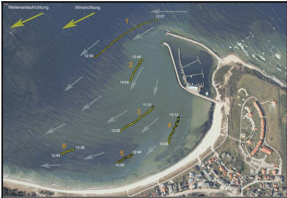
Abbildung 34: Strömungen bei östlichen Winden (Stärke 7-8). Quelle: Autor (mit freundlicher Unterstützung der Universität Rostock)
