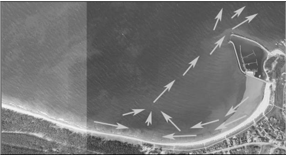
Abbildung 57: Mögliche Sedimentwanderung im Untersuchungsgebiet bei nördlichen Winden und entsprechender Küstenströmung laut Fachliteratur. Durch eine küstennormal ausgerichtete Strömung wird Feinmaterial quer durch die Bucht transportiert und nördlich des Hafens in tieferem Wasser deponiert. Quelle: Autor (nach GELLERT (1965 /1991))
