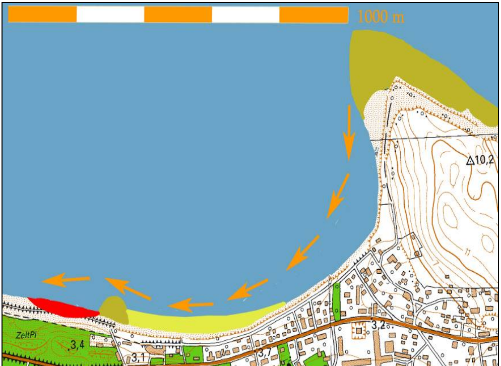
Abbildung 49: Veränderung des Uferverlaufs von 1936 bis heute (schematisch). Die grünlich eingefärbten Flächen deuten den Uferverlauf vor etwa 70 Jahren an. Vor einem kleinen Landvorsprung (links unten) treten Sandstau (gelb) dahinter Materialmangel (rot) zu tage was einen breiten Strand vor dem Seebad und ein Zurückweichen des Ufers vor der Schaabe zur Konsequenz hatte. Quelle: Autor (auf Grundlage von TK)
