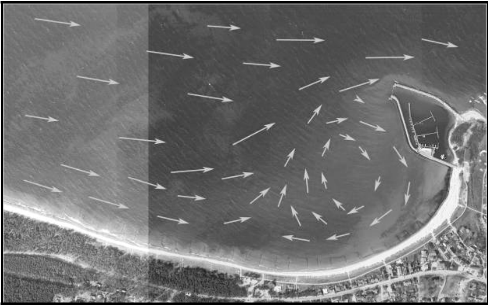
Abbildung 27: Veränderung des Strömungsmusters bei der Erhöhung der Strömungsgeschwindigkeit. Quelle: Autor (nach GELLERT 1965, Luftbild: Mit freundlicher Unterstützung der Universität Rostock)
